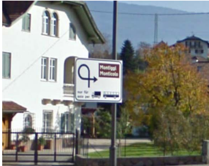
Figura 47: Esempio di segnaletica di avviso della manovra di svolta obbligata per i mezzi pesanti
