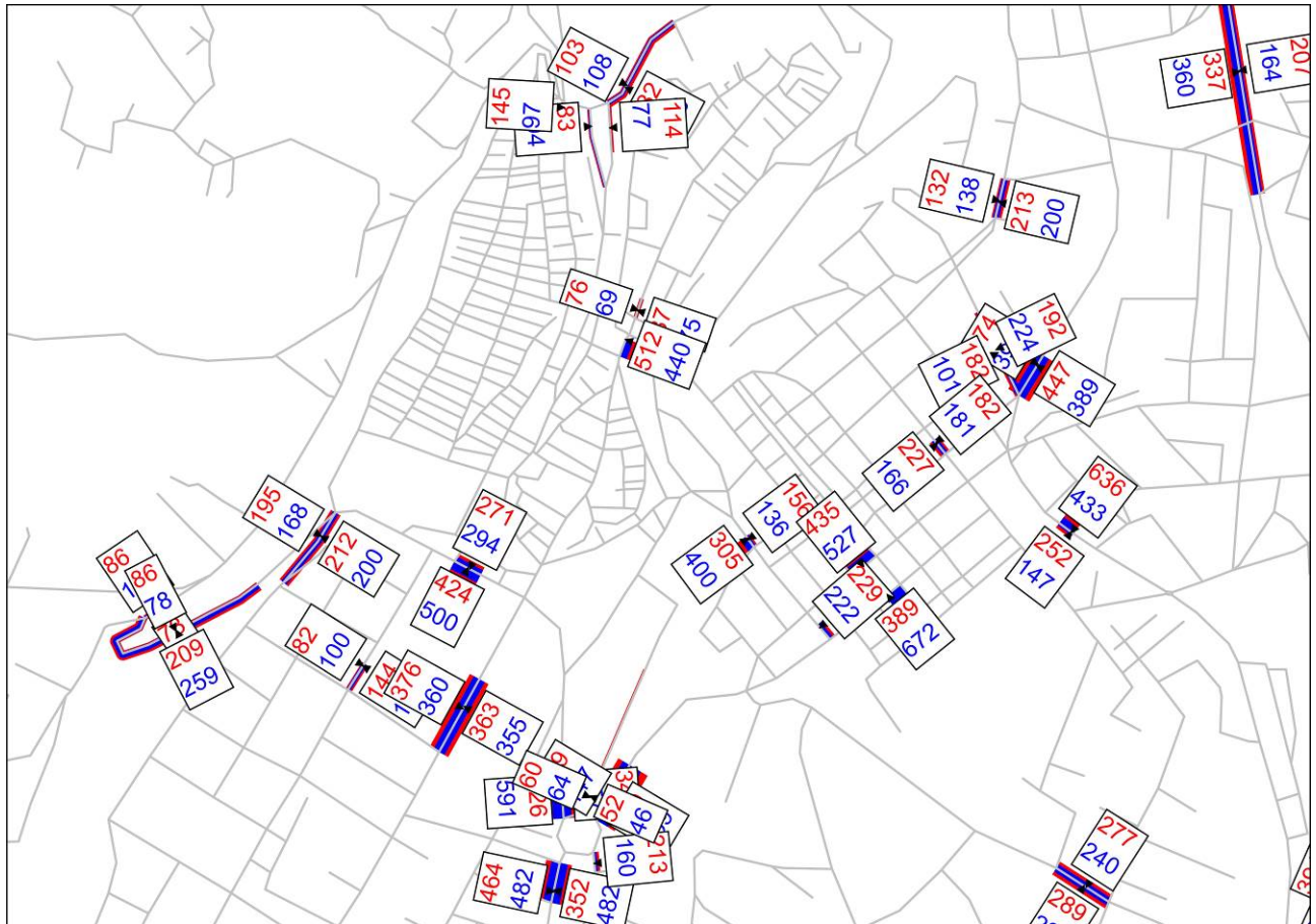
Figura 14. Confronto tra flussi rilevati (in rosso) e flussi stimati da modello (in blu) - ora di punta del mattino.
