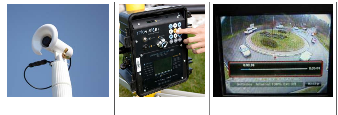
Figura 5: Sistema Miovision: VCU - Control Box - Uscita Video
